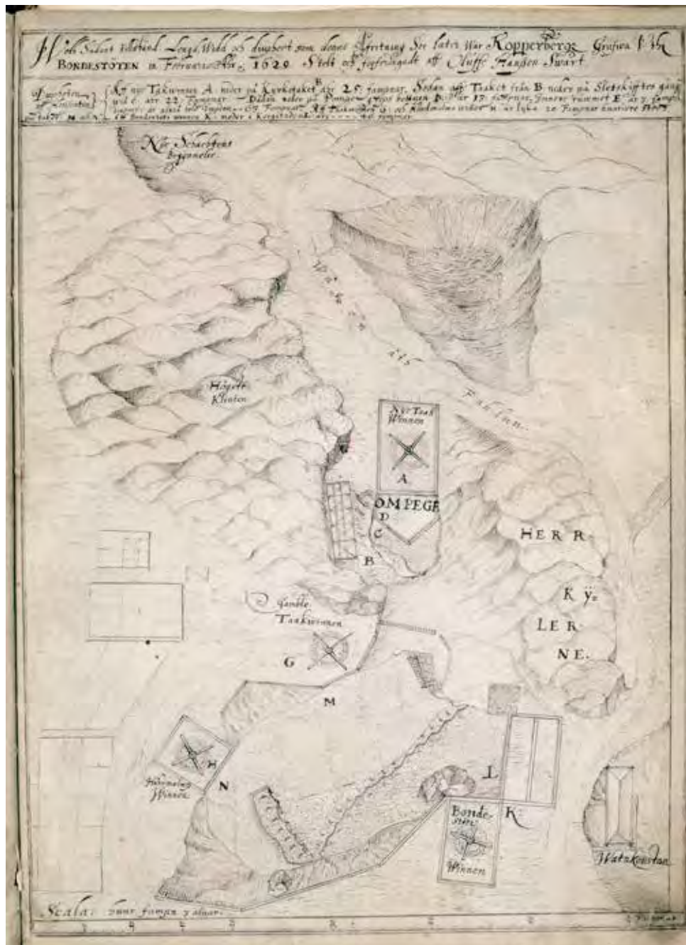
Olof Hansson Swarts karta över Kopparberget 1629, är den äldsta bevarade kartan över gruvan. Den är ritad i fem blad över Bondestöten och två blad över Blankstöten. Varje blad redovisar en viss nivå i gruvan. Genomgående öppningar och schakt markeras med utskurna hål i varje blad. På så vis skapas en tredimensionell bild av gruvan. Det här bladet visar Bondestöten och delar av Blankstöten. Stora Ensos arkiv i Arkivcentrum Dalarna.
